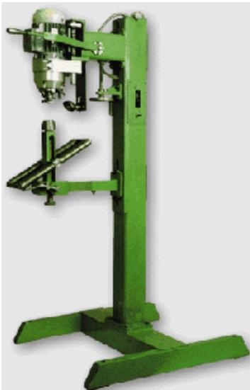
1.2. Принцип действия станка основан на вырезании в протекторе шины столбика резины тонкостенной трубкой с последующим удалением его при обратном ходе трубки.
